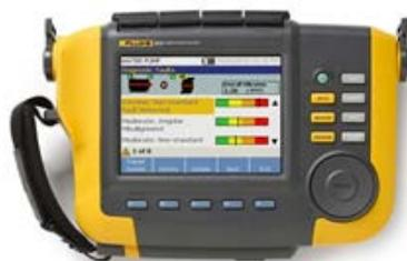
Рис. 11. Устройство измерения акустической вибрации
