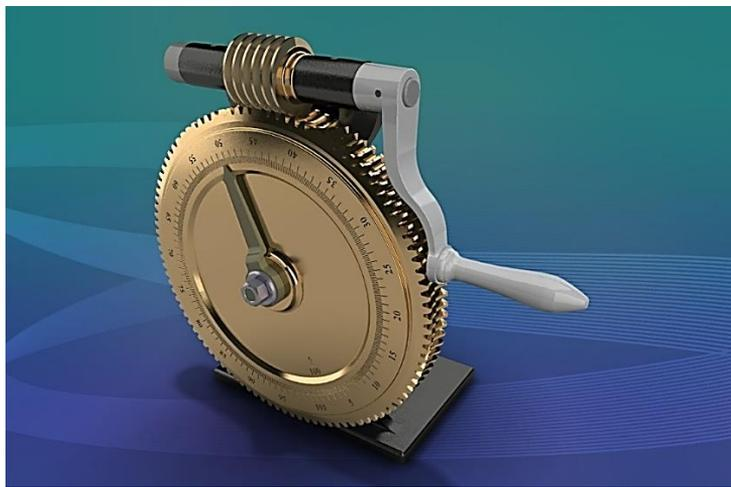
**Рис. 1.** Визуализация модели механизма Фергюсона в САПР «Компас-3D» [3]
