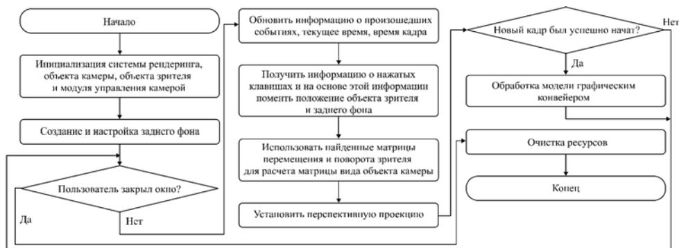
Рис. 3. Блок-схема основного метода
