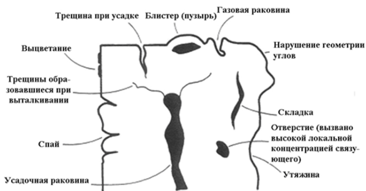
Рис. 1. Дефекты деталей, изготовленных МИМ-способом
