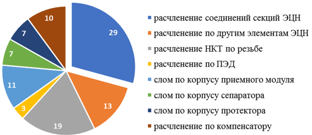
Рис. 2. Виды и соотношение РС-отказов при работе УЭЦН
