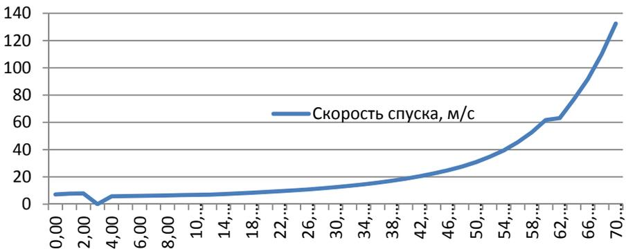
**Рис. 5.** Зависимость скорости спуска от высоты на этапе предпосадочного торможения
