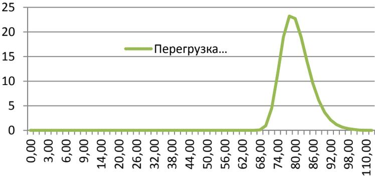
Рис. 3. Зависимость перегрузки от высоты при баллистическом спуске в атмосфере Венеры
