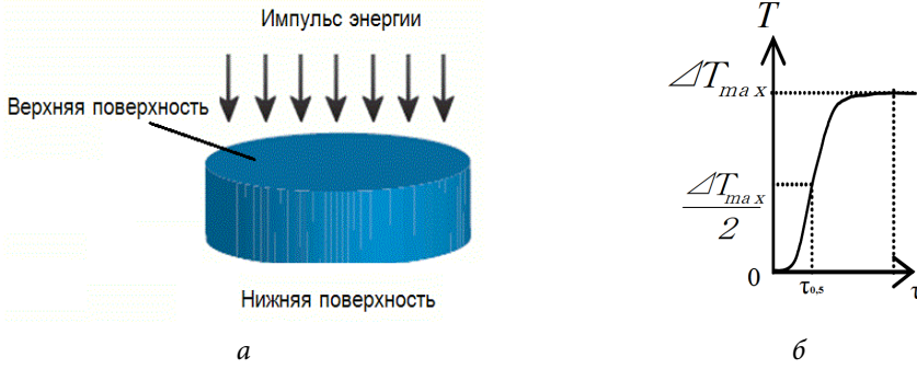
Рис. 1. Схема метода импульсного нагрева (а) и зависимость температуры нижней поверхности ТП от времени (б)
