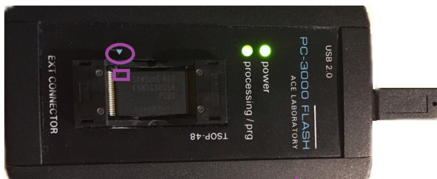
Рис. 5. Считывающее устройство Flash-reader комплекса со вставленной микросхемой памяти
