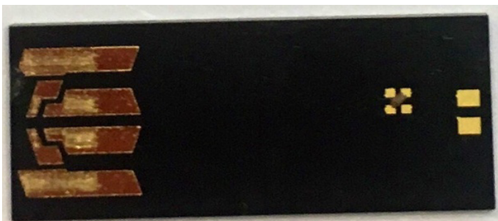
Рис. 2. Современный USB-накопитель в разобранном виде (производитель SAnDick Cruzer Facet; 2 Гбайта)
