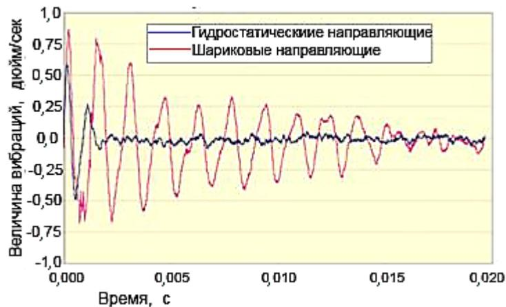
**Рис. 3.** Испытание на виброустойчивость гидростатических и шариковых направляющих методом импульсного возмущения
