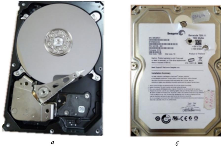
Рис. 1. Общий вид (а) и вид HDD с поднятой крышкой (б)
