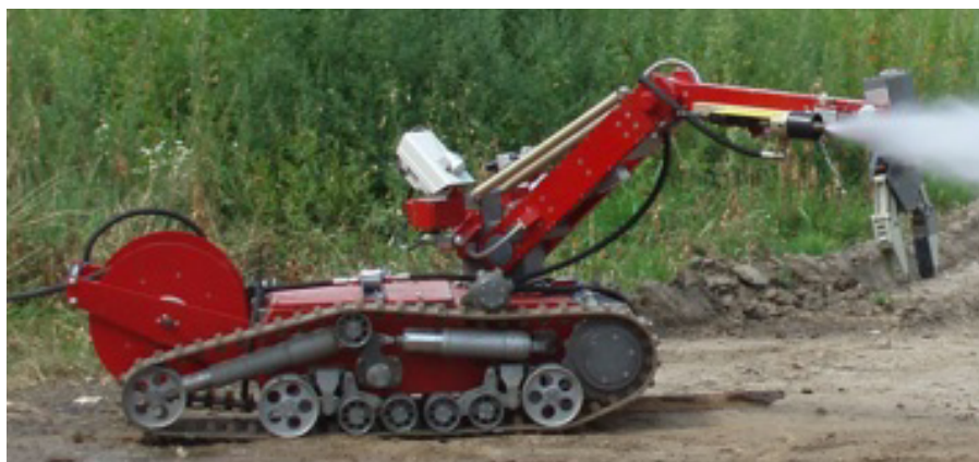
Рис. 1. Мобильный робототехнический комплекс разведки и пожаротушения
