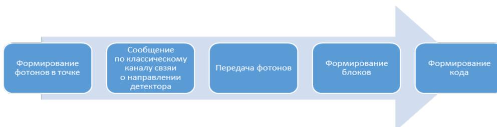
**Рис. 2.** Алгоритм передачи информации по квантовому каналу связи
