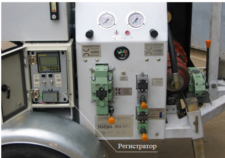
Рис. 6. Регистрационное оборудование на гидравлической тормозной машине
