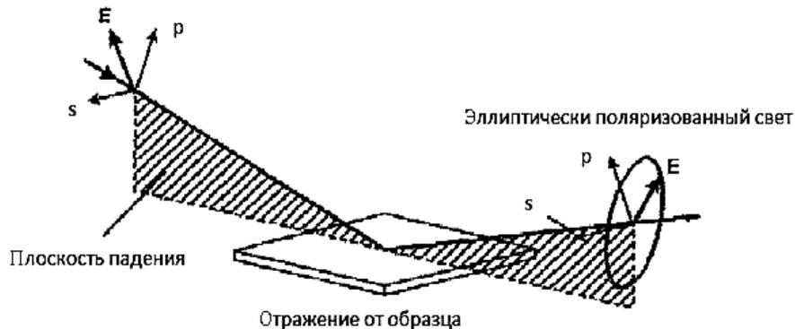
Рис. 3. Взаимодействие поляризованного света с образцом
