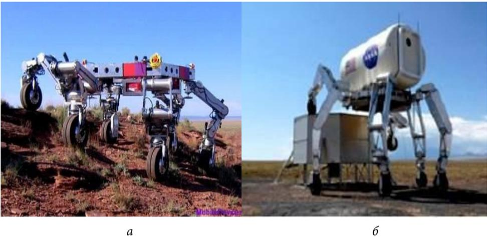
Рис. 8. Колесно-шагающий робот Athlete (США) без отсека (а) и с жилым отсеком (б)
