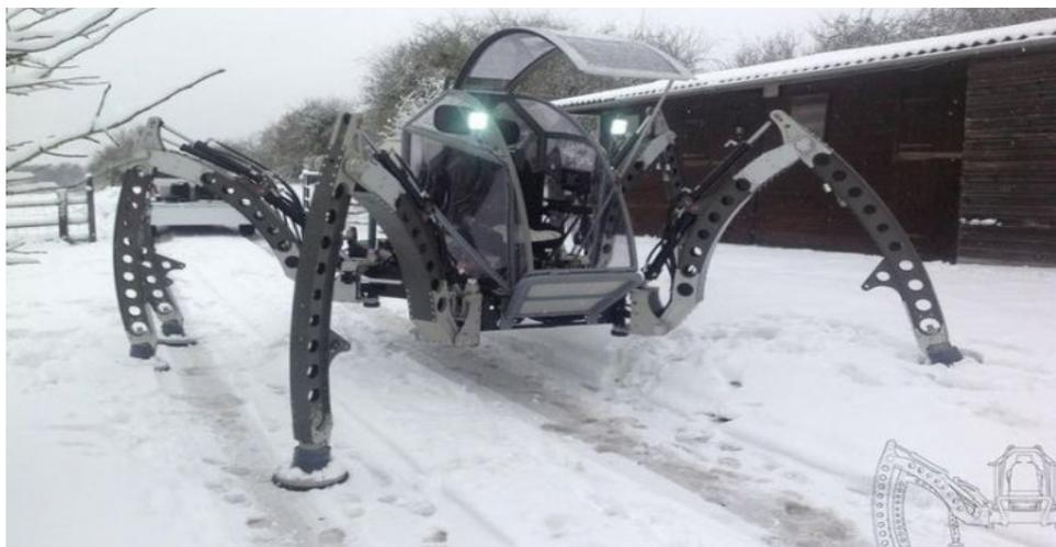
Рис. 10. Пилотируемая шестиногая машина с кабиной закрытого типа — робот Mantis
