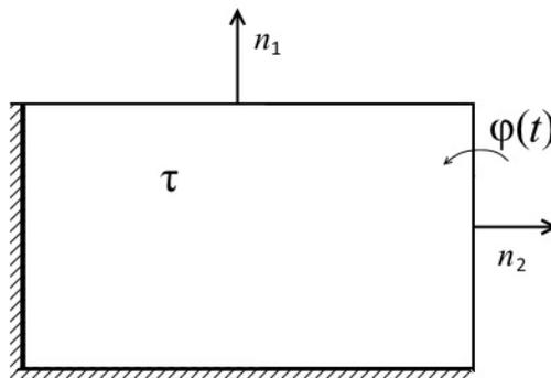
Рис. 3. Краевые условия для бака с жидкостью
