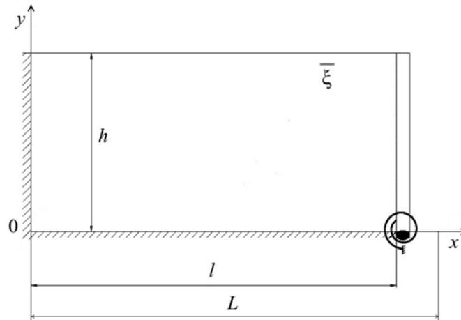
Рис. 1. Модель бака с жидкостью и упругой боковой крышкой
