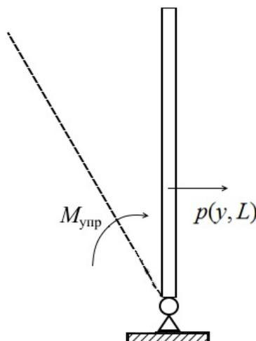
Рис. 2. Упрощенная схема пластины с упругим основанием
