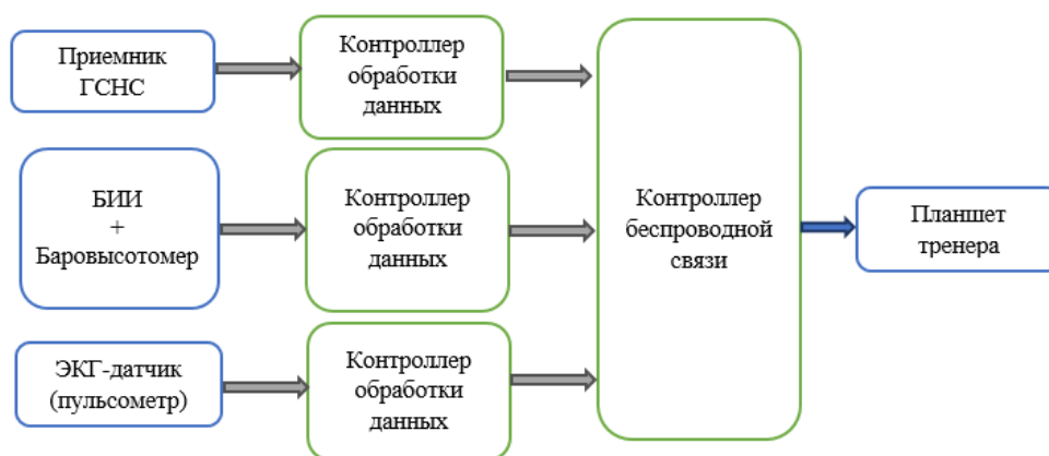
Рис. 2 Функциональная схема разрабатываемого прототипа (при отладке)
