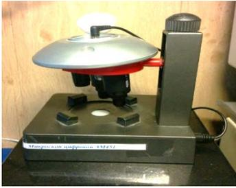
**Рис. 3.** Цифровой оптический микроскоп AM451
