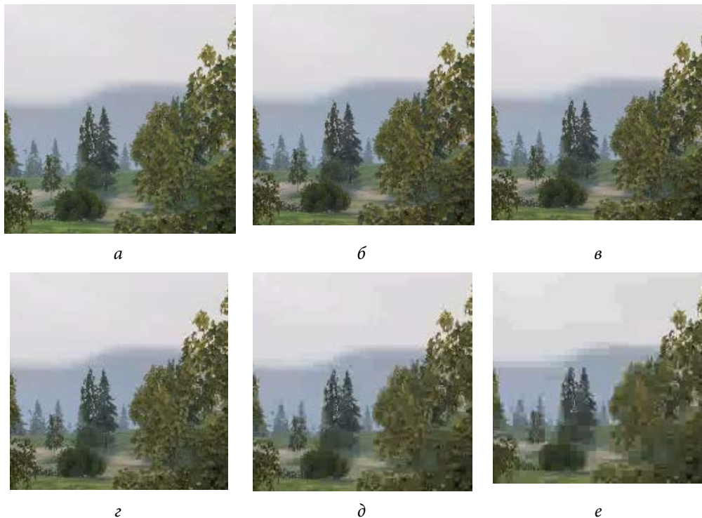
Рис. 4. Фрагмент исходного (а) и сжатых кадров (б–е) с разными коэффициентами квантования: б — 1,00; в — 4,00; г — 10,00; д — 20,00; е — 31,00
