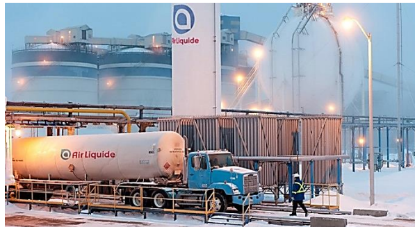
Рис. 1. Заправочный трейлер рядом с газификатором
