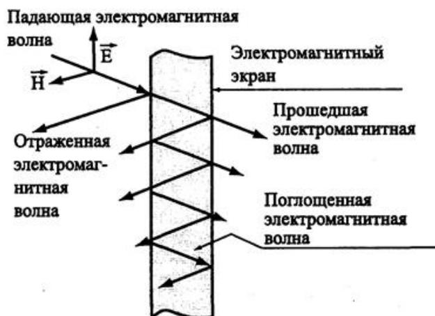
Рис. 1. Экранирование ЭМП плоским экраном
