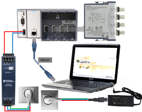
Рис. 1. Схема подключения аппаратной части исследовательского стенда
