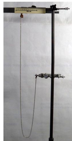
Рис. 12. Цепная линия — форма, которую принимает цепь с закрепленными концами под действием силы тяжести
