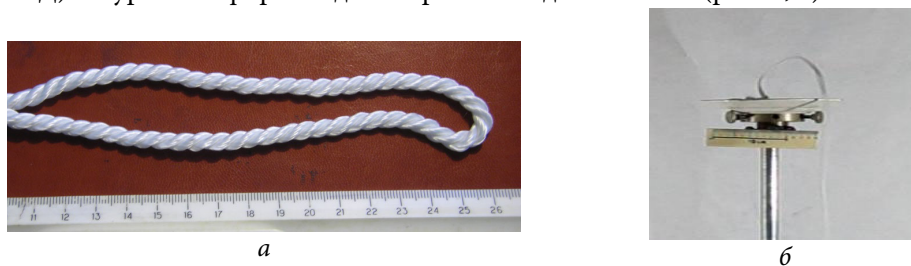
Рис. 3. Шнур полиэфирный диаметром 6 мм длиной 15 м (а); фонтанирование шнура h_1=153 см, h_2=9 см (б)
