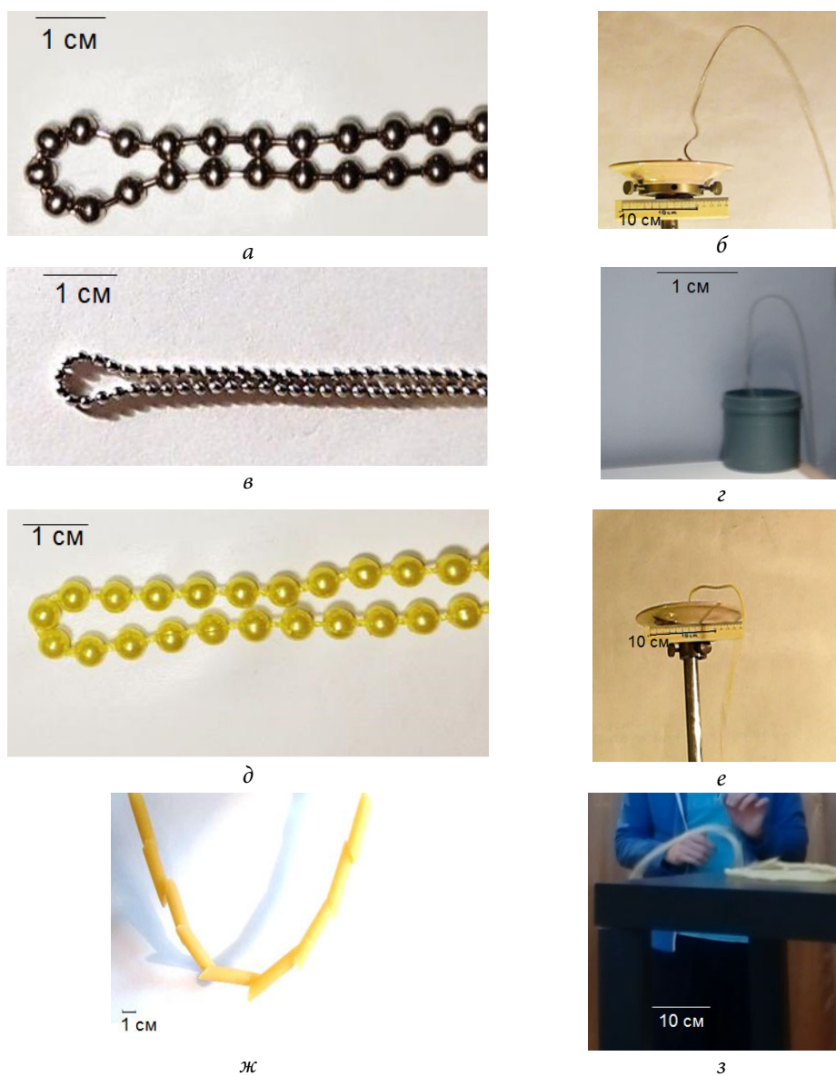
Рис. 2. Фонтанирование цепи А: h_1=215 см , h_2=19,5 см (а, б); цепи Б: h_1=215 см , h_2=12,5 см (в, г); цепи В: h_1=215 см , h_2=5,1 см (д, е); цепи Г: h_1=215 см , h_2=11 см (ж, з)
