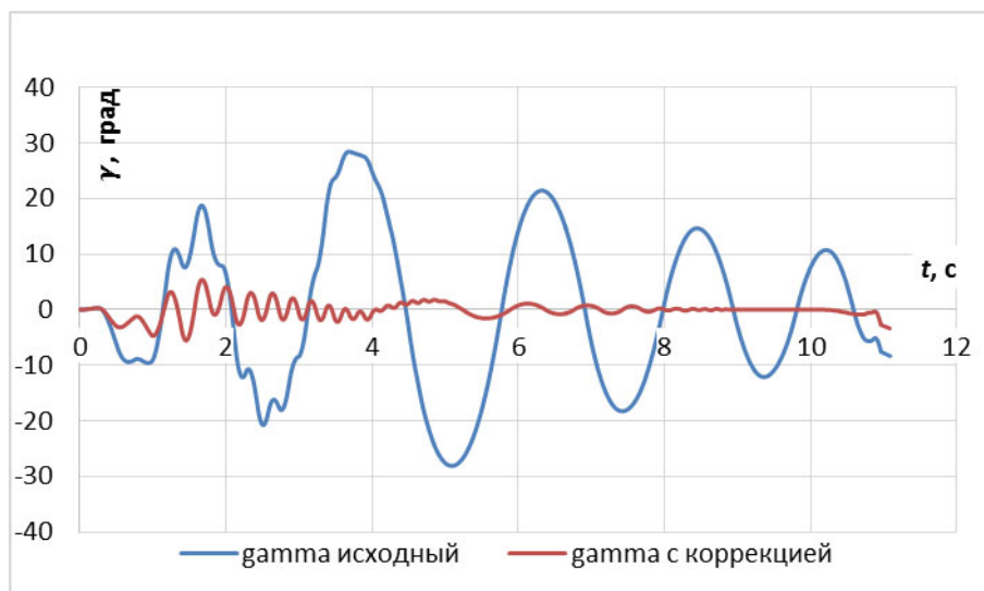
Рис. 9. Сравнение зависимости угла крена от времени при скорректированном и нет законе управления
