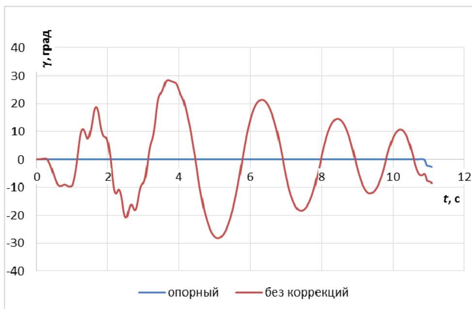
Рис. 5. Зависимости угла крена от времени для различных законов управления
