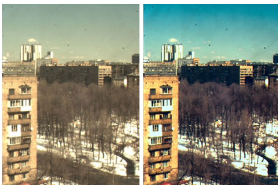
Рис. 6. Результат обработки по шаблону Байера (слева) и гамма-коррекции (справа)
