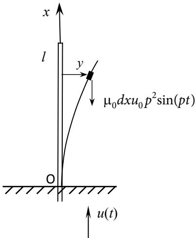
Рис. 2. Схема нагружения балки
