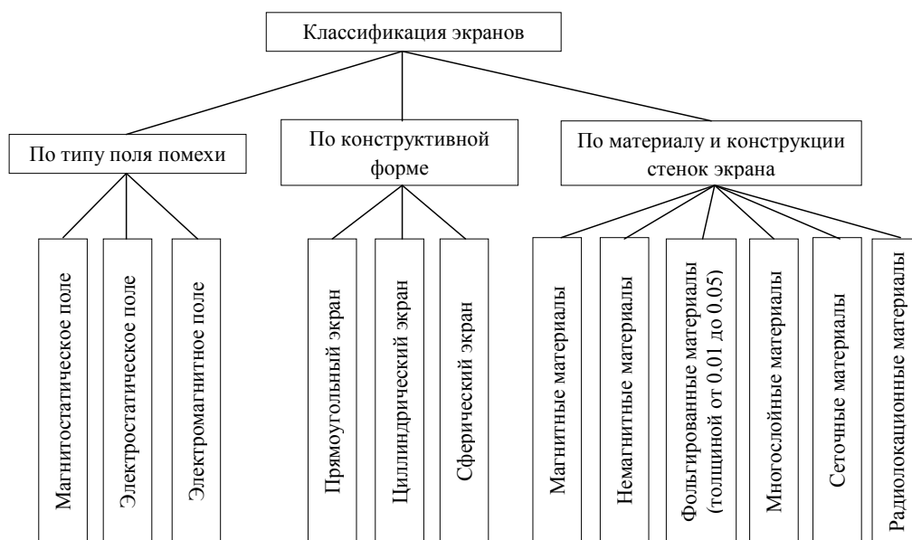
Рис. 2. Классификация электромагнитных экранов
