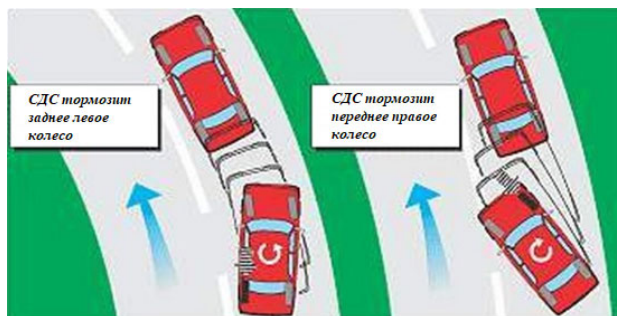
Рис. 1. Работа СДС при сносе передней оси (слева) и заносе задней оси автомобиля (справа)
