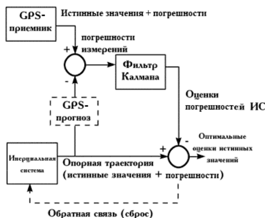
Рис. 1. Схема коррекции ИНС с использованием GPS
