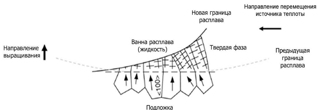
Рис. 7. Схема образования границы между слоями
