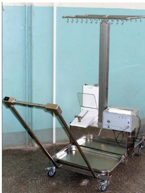
Рис. 1. Опытный образец АК в режиме фильтрации гемотрансфузионных сред
