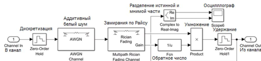
Рис. 2. Имитационная модель канала распространения
