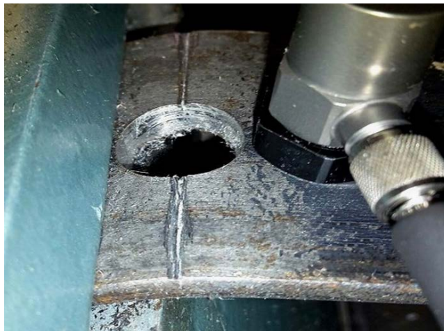
Рис. 2. Пьезоэлектрический датчик ускорений, установленный на пластине
