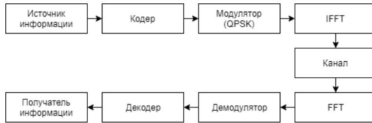
Рис. 3. Структурная схема OFDM-системы с применением кодирования
