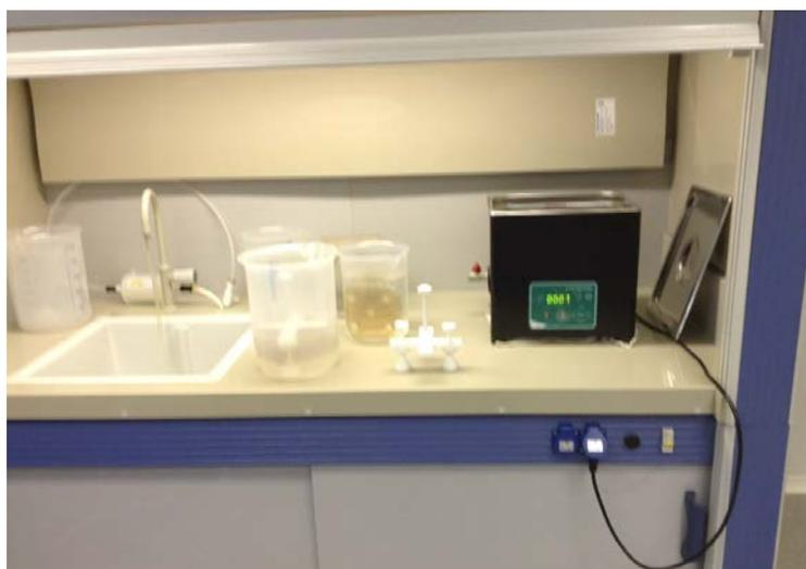
**Рис. 1.** Рабочее место для травления моноблока
