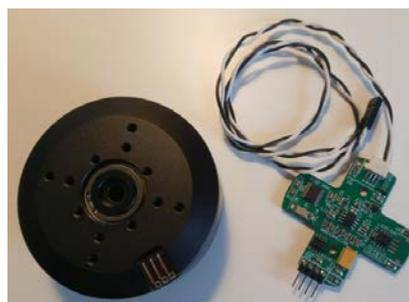
**Рис. 1.** Двигатель iPower GBM6212H-150T и плата датчика абсолютного положения ротора
