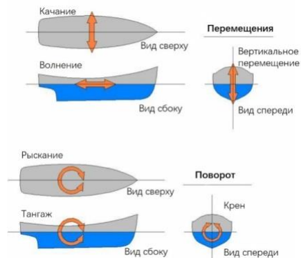
Рис. 1. Движение палубы с шестью степенями свободы
