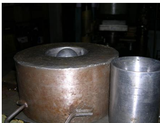
Рис. 1. Контейнер со свинцом после штамповки детали и матрица
