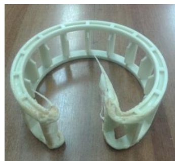
Рис. 4. Результаты ВЧ-диагностирования полиамидного сепаратора без применения электродов
