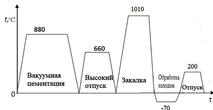
Рис. 3. Схема химико-термической обработки с вакуумной цементацией стали ВКС-7
