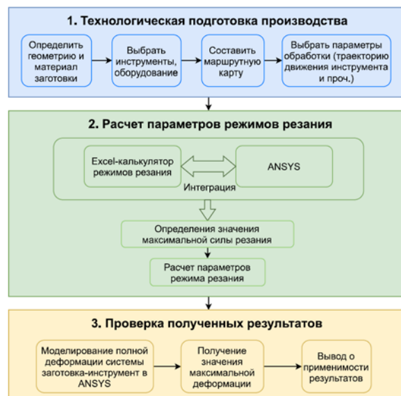
Рис. 7. Схема программной и технологической реализации алгоритма определения режимов резания
