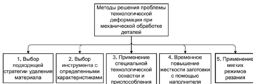
Рис. 2. Методы уменьшения деформации при обработке тонкостенных деталей
