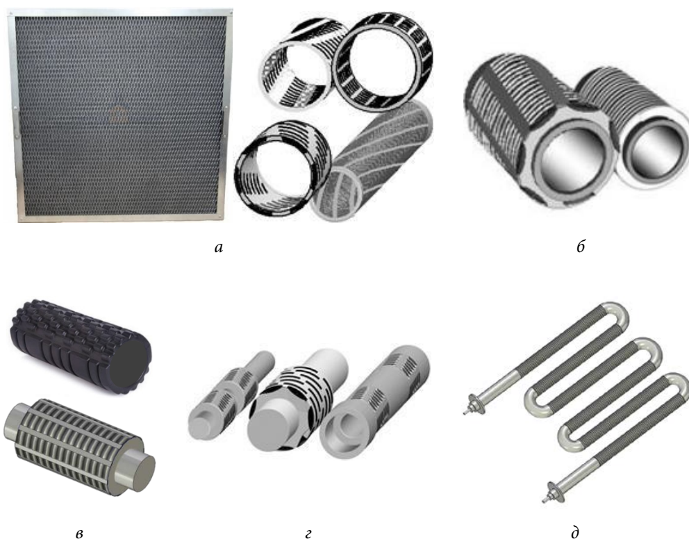
Рис. 1. Детали, изготавливаемые методом циклоидального электрохимического формообразования:
