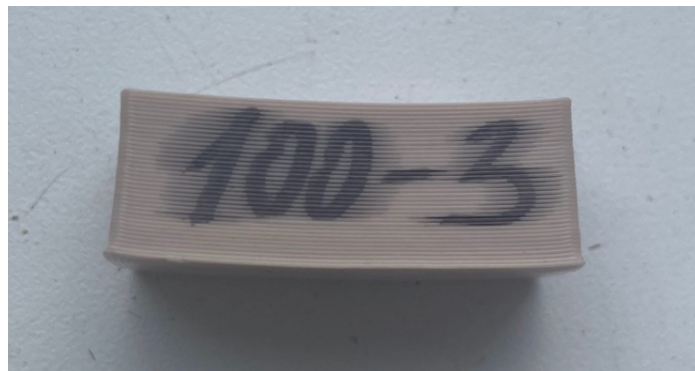
Рис. 8. Образец после проведения термической обработки с нагревом до 100 °С
