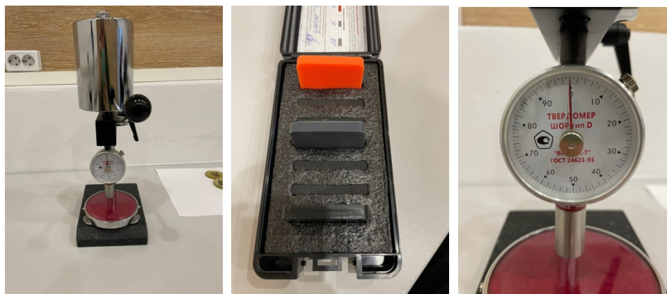
Рис. 6. Твердомер, работающий по методу Шора
