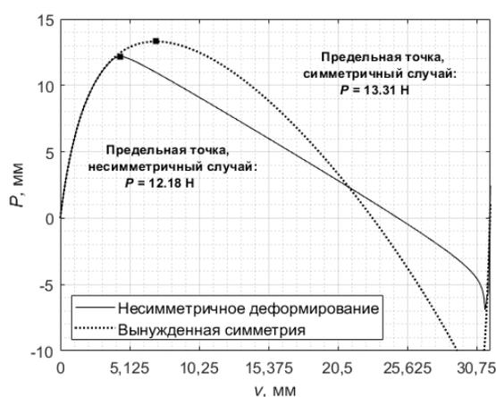
Рис. 8. Упругие характеристики для задачи с различной жесткостью левой и правой спиральных пружин
