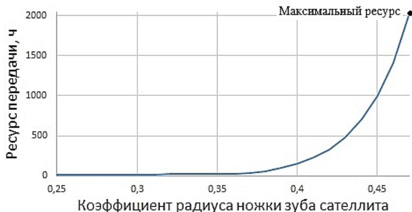
Рис. 7. Зависимость ресурса от коэффициента радиуса ножки зуба сателлита при работе на шестой передаче
