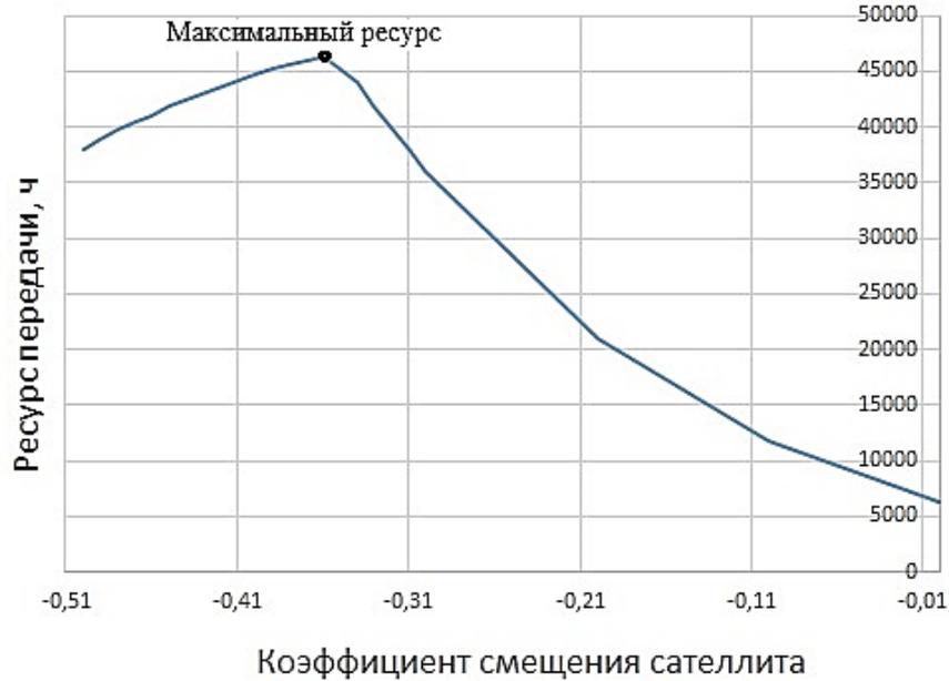
**Рис. 5.** Зависимость ресурса от коэффициента смещения сателлита при максимальном радиусе ножки зуба сателлита при работе на четвертой передаче
