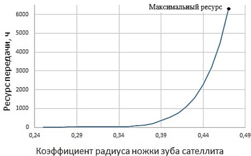
**Рис. 3.** Зависимость ресурса от коэффициента радиуса ножки зуба сателлита при работе на четвертой передаче
