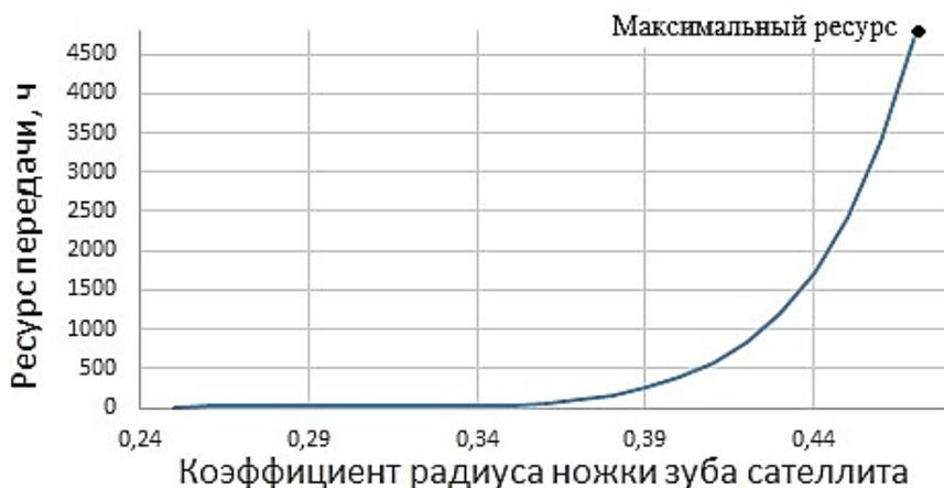
**Рис. 11.** Зависимость ресурса от коэффициента радиуса ножки зуба сателлита при работе на второй передаче заднего хода
