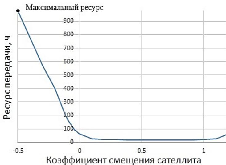
Рис. 8. Зависимость ресурса от коэффициента смещения сателлита при работе на шестой передаче
