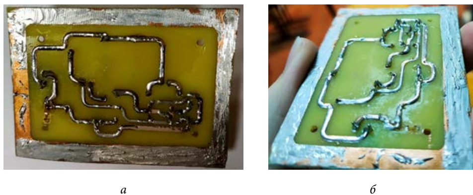
Рис. 3. Отмывка платы, загрязненной флюсом ER-700-BR, в ацетоне: а — ПП до отмывки; б — ПП после отмывки
