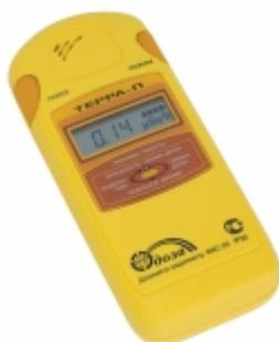
Рис. 5. Дозиметр-радиометр бытовой MKC-05 «Терра-П» [8]
