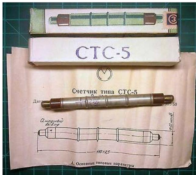
Рис. 1. Газоразрядный счетчик СТС-5
