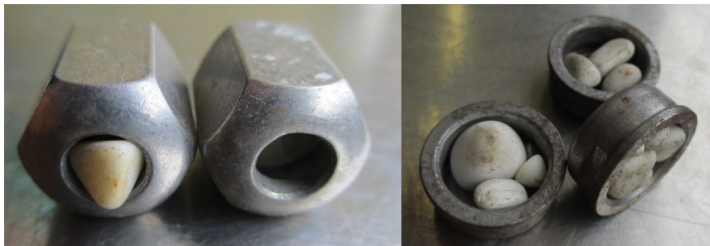
Рис. 2. Примеры неправильно подобранных абразивных тел, застрявших в полостях (отверстиях) деталей
