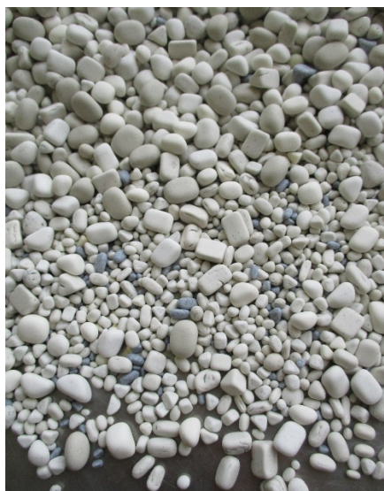
Рис. 4. Пример наполнителя ПТ 10×10 различной степени изношенности
