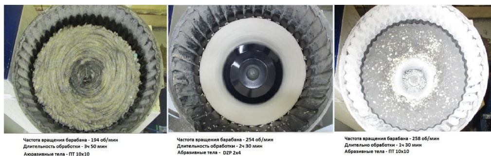
Рис. 5. Процесс галтовки деталей с различными наполнителями и режимными параметрами (вид на роторный барабан сверху)
