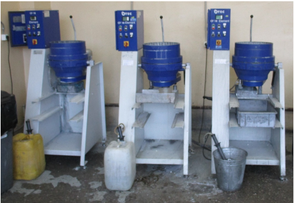
Рис. 1. Роторные установки OTEC CF 18 Element Wet (объем барабана 18 л)
