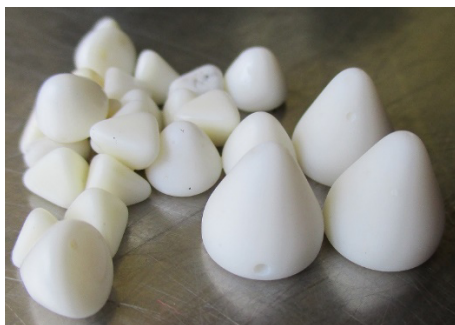
Рис. 3. Пример наполнителя КХ-10 изношенного (слева) и нового (справа)
