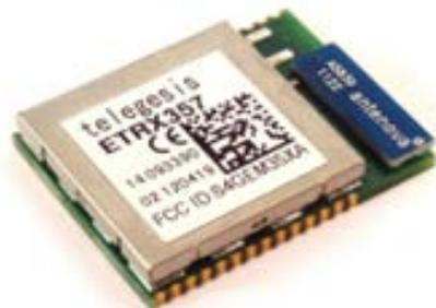
Рис. 2. Модуль ZigBee
