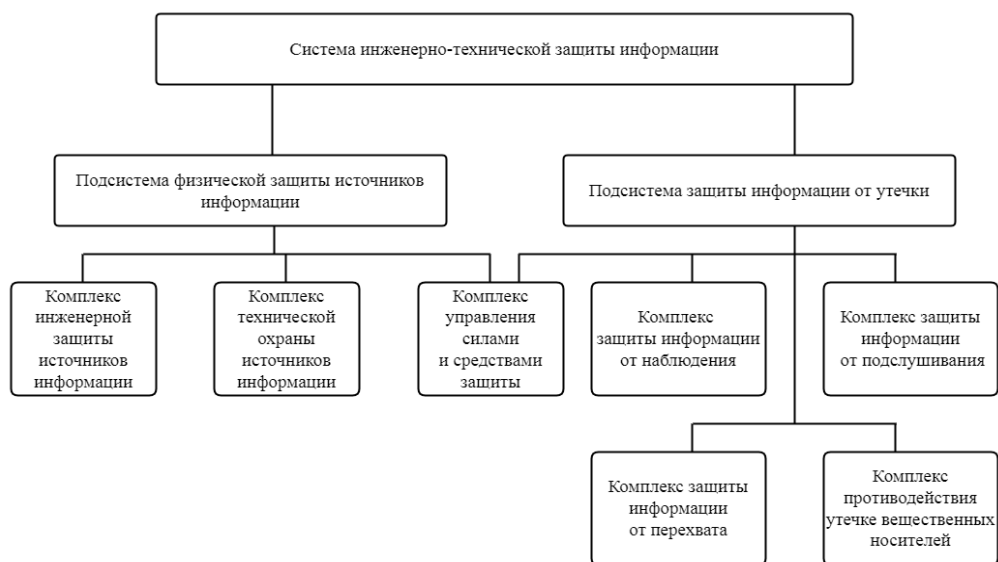
Структура системы инженерно-технической защиты информации
