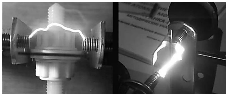
Рис. 2. Искровой разряд вблизи диэлектрической пластины с микрорельефом
